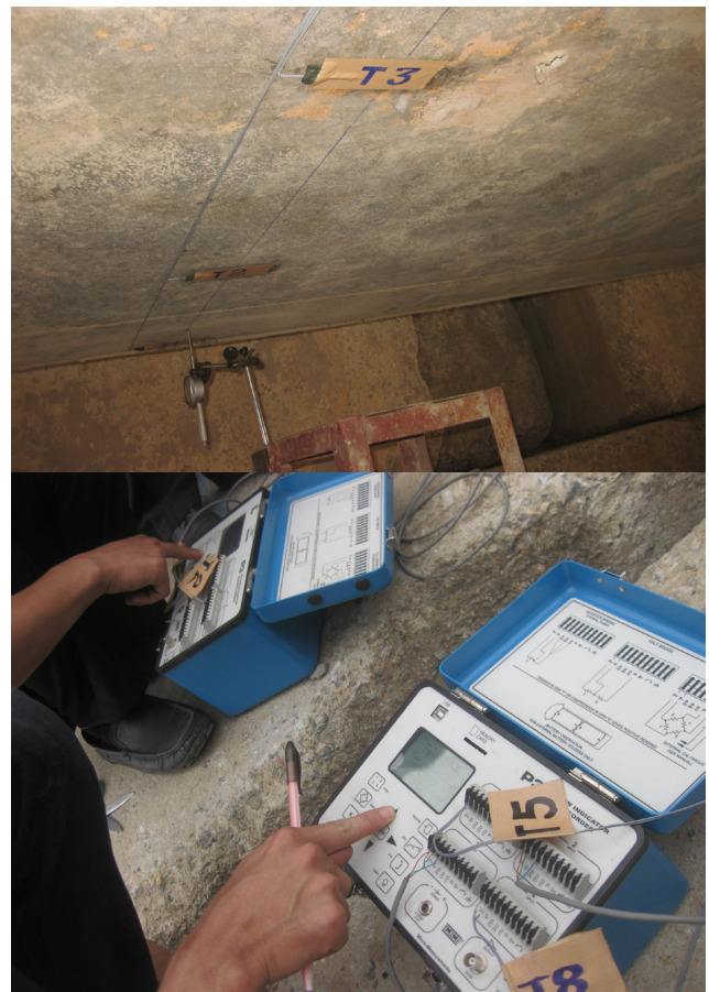
H.7. Ghi nhận số liệu đo biến dạng bê tông dầm trên máy hiển thị số Data logger P3 (b)
